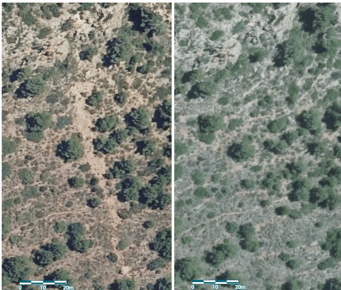
Figura 12.- La comparació de les dues ortofotos permet observar (a l'esquerra) una imatge recent on es veu un bloc (extrem inferior) i la seua trajectòria de Nord a Sub. A la dreta, una imatge anterior al despreniment permet apreciar millor quina era la posició del bloc abans de caure.
